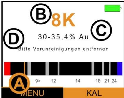
Stelle des Objektes auf. Idealerweise eine Stelle an der sie möglichst viel Kontaktfläche haben. Drücken Sie leicht auf und schon startet die Messung automatisch – es erfolgt die Ausgabe „Messung läuft...“. Warten Sie wenige Momente ab bis die Messung abgeschlossen ist (siehe unten).
